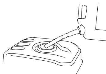
Figura 10 – Agregado de combustible
